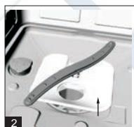
Шаг 1: Поверните фильтр грубой очистки против часовой стрелки, затем выньте его.
